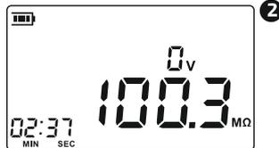
Не прикасайтесь к открытым токоведущим проводникам сразу после измерения, электрический заряд, накопленный в цепи, может привести к поражению электрическим током.
