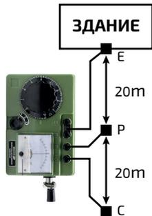
**ИЗМЕРЕНИЕ СОПРОТИВЛЕНИЯ ЗАЗЕМЛЯЮЩЕГО УСТРОЙСТВА.**
