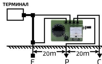
Для повышения точности измерений при сопротивлении заземления менее 1 Ом, снимите перемычку с клемм «Е» и подключите их к заземлителю раздельными кабелями.
