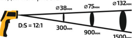
*Расстояние и размер пятна, на котором измеряется температура.*
