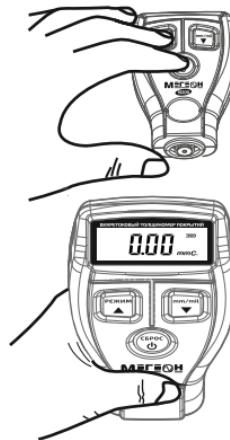
На этом калибровка закончена. Включите прибор кнопкой **ZERO/()** и можно измерять толщину покрытий на том основании, на котором проводилась калибровка.
