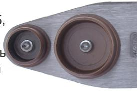
Установите аппарат на подставку, выставите нужную температуру и включите в сеть. Загорится зелёный индикатор нагрева, через 3...5 минут, когда аппарат достигнет рабочей температуры, погаснет индикатор нагрева и загорится красный индикатор готовности – можно приступать к сварке. Время нагрева аппарата зависит от температуры и движения воздуха в помещении, где проводится сварка.
