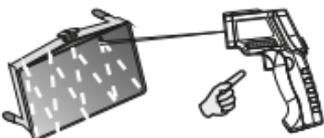
зафиксированную температуру. После окончания измерения отпустите курок, измеренные значения зафиксируются – режим «**HOLD**». При следующем нажатии курка начнётся новое измерение – предыдущие измеренные значения сбросятся.
