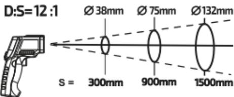
то измеряемое пятно будет иметь диаметр около 5 см, на расстоянии 3 м, измеряемое пятно будет диаметром около 25 см и т.д., кроме этого нужно учитывать, что прибор показывает усреднённое значение по всему пятну измерения, и если размер объекта меньше диаметра пятна, будет ошибка в измерении. Достоверным нужно считать результат измерения, если пятно в два или более раз меньше объекта, поэтому в зависимости от размера измеряемого объекта выбирайте расстояние до него.
