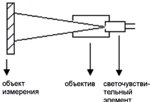
Необходимо удостовериться, что обследуемый объект целиком перекрывает поле зрения термометра, и в поле зрения не попадает ничего, кроме объекта. Чем больше объект измерения, тем больше может быть расстояние между ним и термометром при измерении температуры. Чем меньше объект, тем ближе к нему необходимо размещать термометр. Соотношение между расстоянием до объекта и его размером (D:S) составляет 12:1, как показано на следующей схеме:
