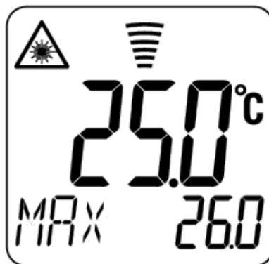
Если измеренная температура выходит за диапазон оповещения об опасности, т.е. больше, чем на заданное значение верхнего предела оповещения об опасности (HAL), или оказывается ниже температуры окружающей среды на величину большую, чем заданный нижний предел оповещения об опасности (LAL), на приборе загорается красный светодиодный индикатор. В иных случаях загорается зеленый индикатор.
