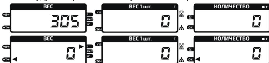
Для отключения функции тарирования на ненагруженных весах нажмите кнопку
